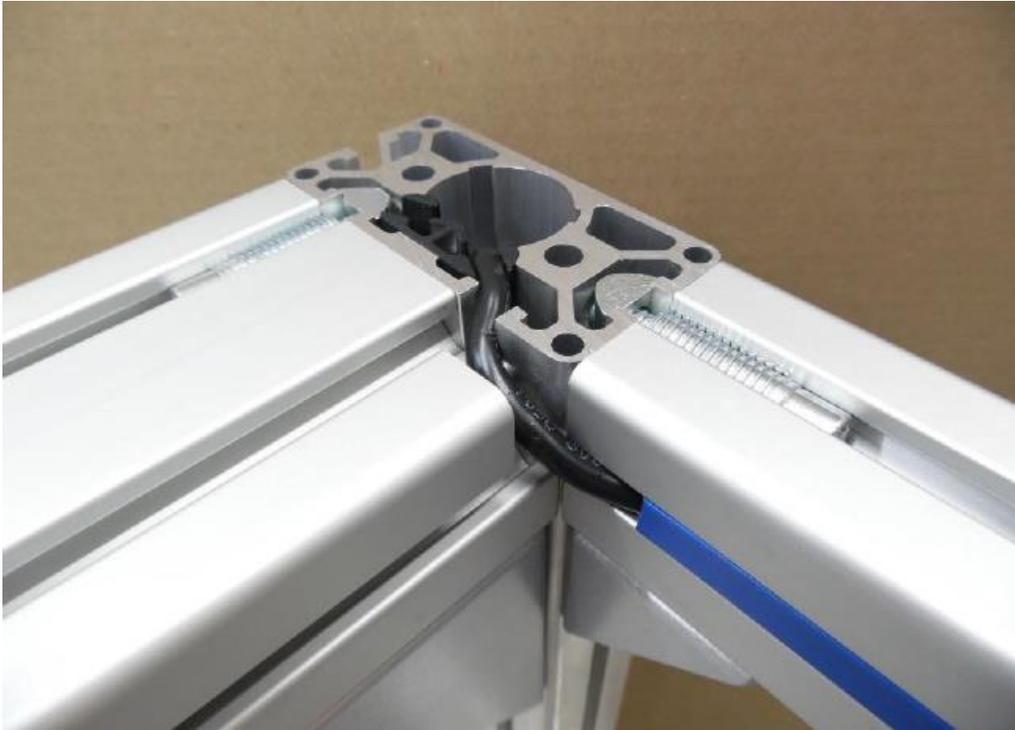
Abbildung 27 Kabelführung in der Nut mit Abdeckung
