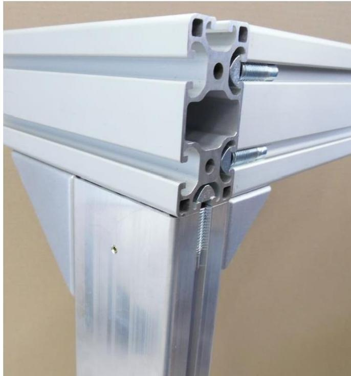
Abbildung 9 Abstützende Anbindung Grundrahmen am stirnseitigen Außenprofil der Hubelemente
