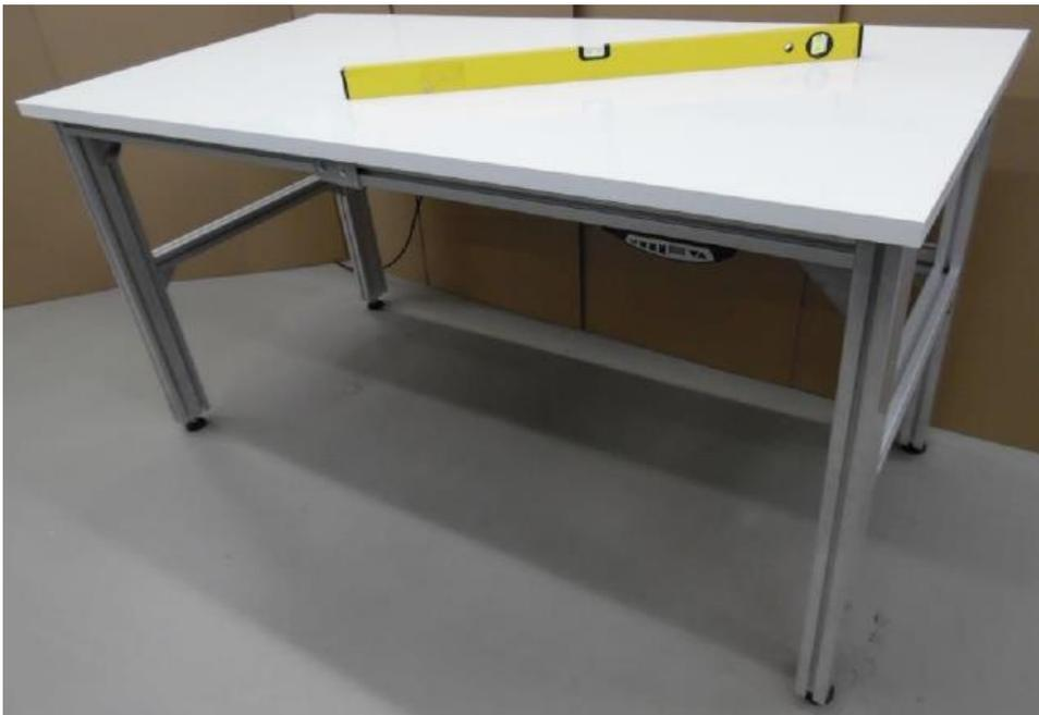
Abbildung 30 Einstellen des Arbeitsplatzes mit Wasserwaage
